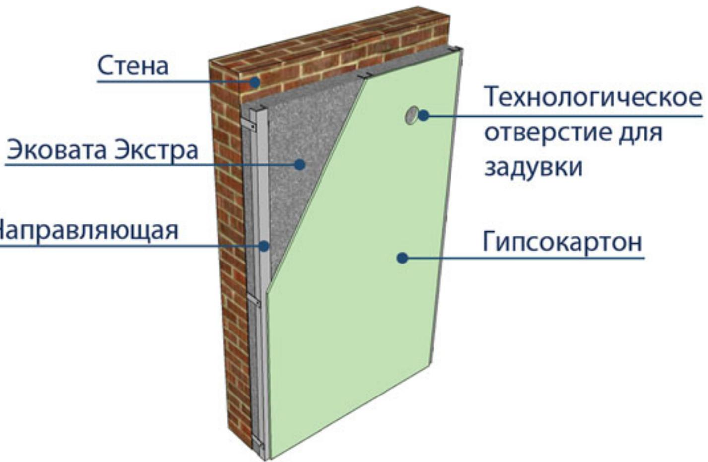
**Совет:** при задувке в ограниченные пространства важно предусмотреть выход воздуха. Для этого технологическое отверстие необходимо сделать больше, чем диаметр шланга, а оставшееся вокруг него пространство укрыть дышащим материалом, используя его в качестве фильтра.
