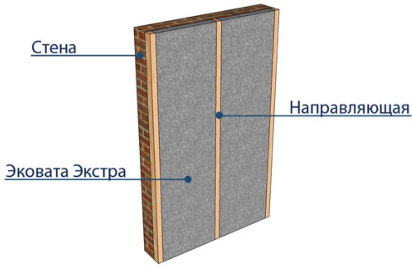
**Совет:** данное решение теплоизоляции, применяется только в теплое время года, чтобы обеспечить полное высыхание утеплителя.
