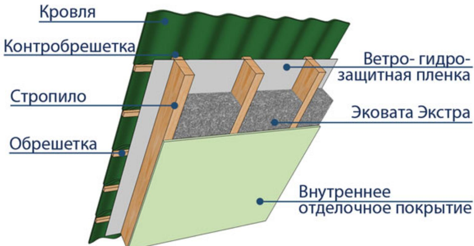
**Совет:** если направляющие деревянные, удобен способ нанесения под дышащие пленки, что позволяет наблюдать за процессом заполнения и контролировать качество заполнения пустот.
