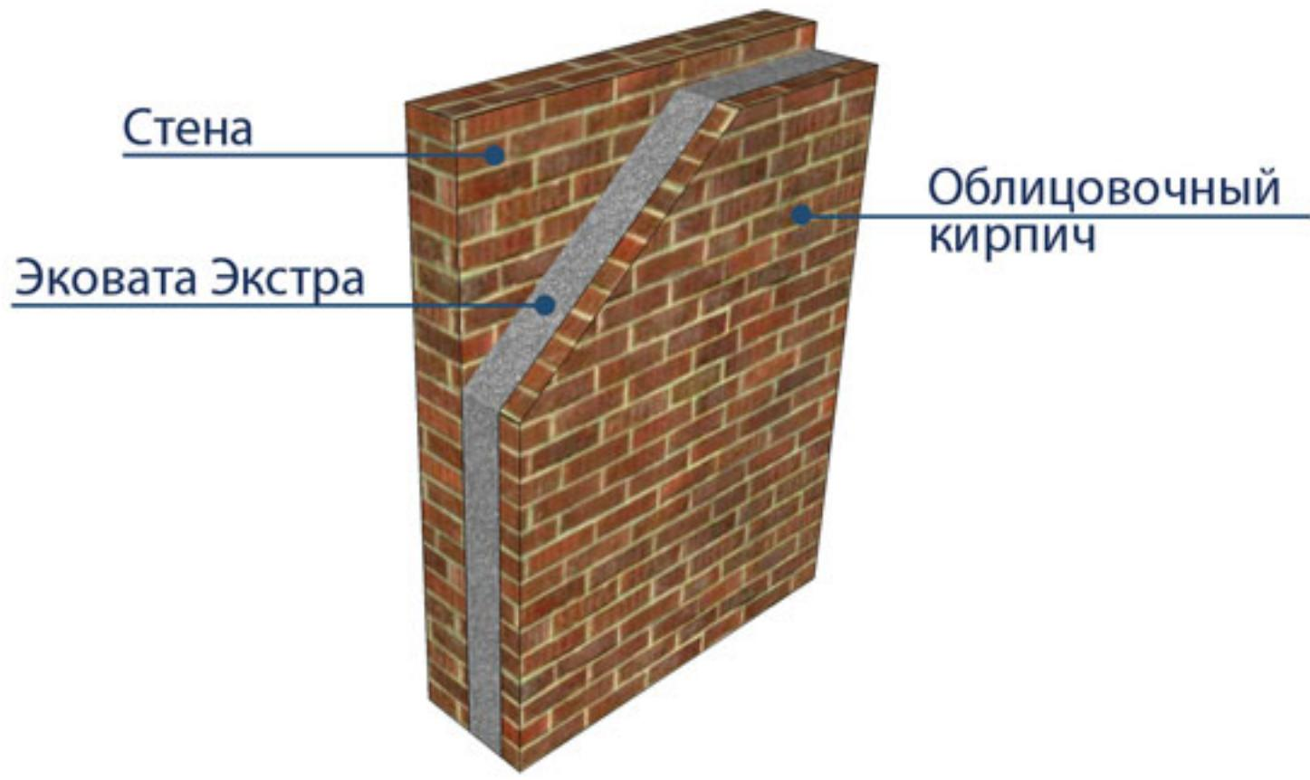
**Совет:** монтаж в слоистую кладку удобен на стадии строительства. Для монтажа в этом случае оптимально подойдет именно ручной способ, насыпая утеплитель слоями в поднятый кирпичный пояс до установки кладочной сетки.
